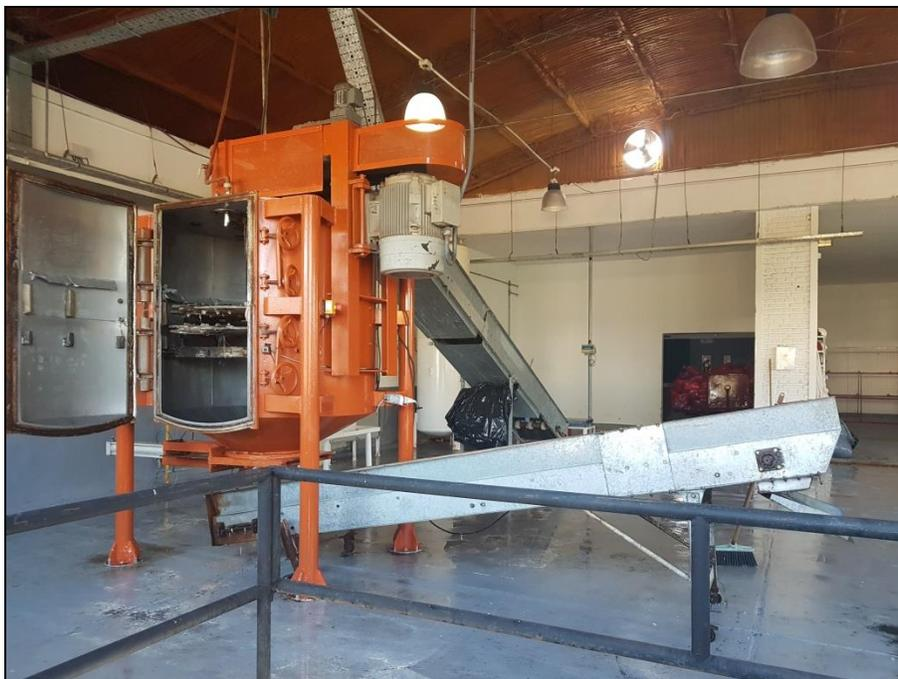
*Imagen 17 - Equipo de destrucción, desinfección y esterilización.*
