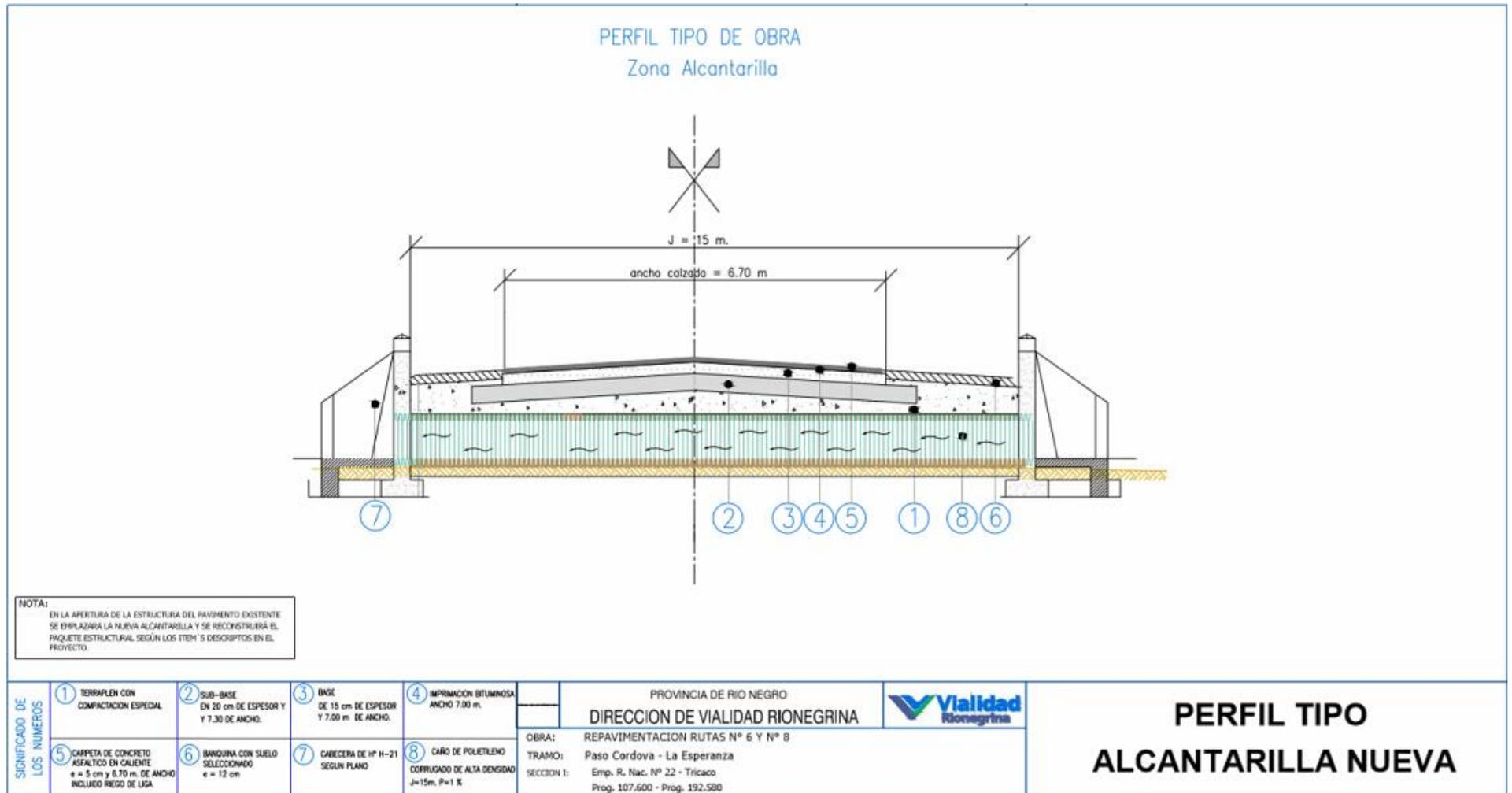
Figura 12. Perfil de reparación de alcantarilla 136+470
