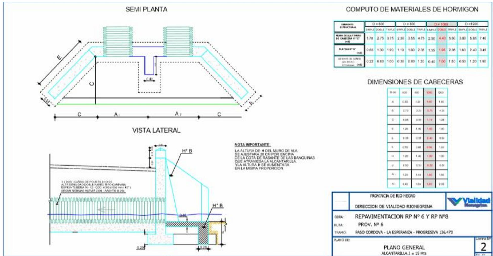
Figura 13. Perfil de reparación de alcantarilla 144+220
