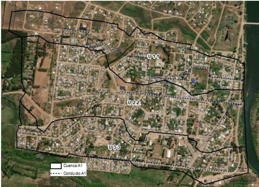
Figura 37: Esquema de subcuencas y conductos principales Alternativa N°1.
